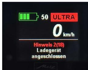
Diese beiden Hinweise bleiben am Display so lange sichtbar, bis der Akku vollständig aufgeladen ist. Danach geht die Displayanzeige in den Grundzustand und das Fahrrad schaltet sich automatisch nach ca. 20 Minuten aus.
