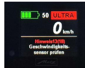
Mögliche Ursachen sind eine fehlerhafte Verbindung zwischen Sensoreinheit (diese befindet sich mittig an der linken unteren Hinterradstrebe) und dem Antrieb, oder der Gebermagnet, welcher an einer Speiche im Hinterrad befestigt ist, ist verrutscht oder fehlt ganz.
