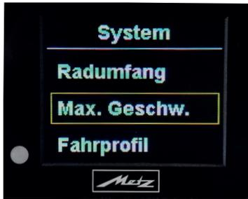
Mögliche Einstellungen sind "Auto" (Auslieferungszustand) und von "6km/h" in 1km-Schritten bis hin zu "25km/h".
