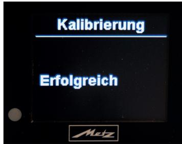
Um das Untermenü "Kalibrierung" wieder zu verlassen, muss im Anschluss die **Taste 3 oder 4** gedrückt werden.
