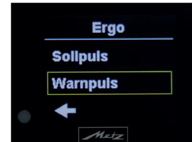
Mit den **Tasten 2 und 3** haben Sie nun die Möglichkeit einen Warn-Pulsschlag von **Sollpuls+5/min** bis **Sollpuls+20/min** in Einer-Schritten anzuwählen und mit der **Taste 4** zu bestätigen.
