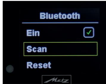
Danach startet das System die Suche nach koppel-fähigen Geräten. Wird ein zu koppelndes Gerät erkannt (hier Puls-Armband), so wird es im Display angezeigt. Wenn Sie mit dem angezeigten Gerät verbunden werden möchten, müssen Sie den angezeigten **"BT-Code"** mit der **Taste 4** bestätigen und gelangen automatisch wieder zurück ins Bluetooth-Menü.
