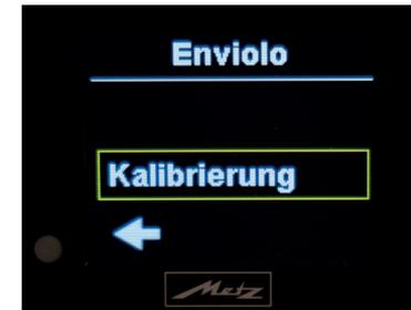
Um den Vorgang abzubrechen, wählen Sie mit den **Tasten 2 und 3** den Rücksprungpfeil an und Bestätigen dies mit der **Taste 4**. So gelangen Sie wieder ins "**Hauptmenü**". Oder Sie führen den Kalibriervorgang weiter fort, indem Sie den ausgewählten Menüpunkt "**Kalibrierung**" mit der **Taste 4** bestätigen.
