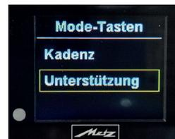
Wählen Sie "**Kadenz**", dann bewirkt ein kurzer Tastendruck auf die **Mode-Tasten** im Hauptmenü eine Veränderung der Kadenz, ein langer Tastendruck eine Veränderung der Unterstützungsmodi. Wählen Sie "**Unterstützung**", so ändern Sie mit einem kurzen Tastendruck die Unterstützungsmodi und mit langem Druck die Kadenz
