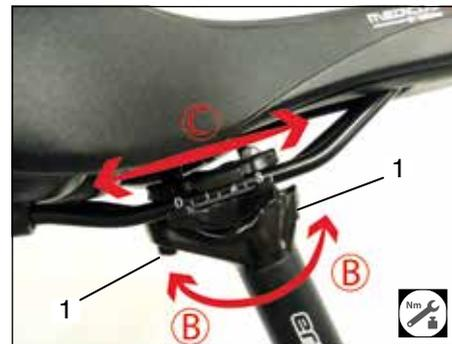
Der Sattel kann zudem geneigt und in Längsrichtung eingestellt werden.
