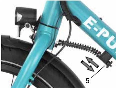
Der E-PULSR ist mit einem Lenkungsdämpfer ausgestattet. Dieser sorgt dafür, dass beim Abstellen des E-PULSRs der Fahrradlenker zentriert bleibt. Dadurch wird beim "Parken" des E-PULSRs mehr Stabilität erzielt, vor allem wenn Sie noch eine zusätzliche Last (z.B. KlickFix-Korb) am Lenker angebracht haben.
