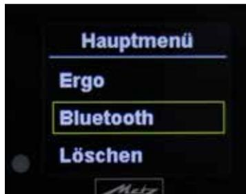
Wählen Sie im Hauptmenü den Menüpunkt "**Bluetooth**" an. Mit einem kurzen Tastendruck auf **Taste 4** gelangen Sie in das Bluetooth-Menü.
