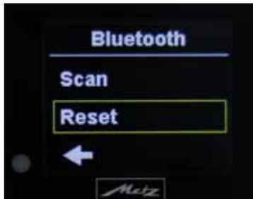
Um mit Bluetooth-Geräten verbunden zu werden, müssen Sie mit den **Tasten 2 / 3** den den Untermenüpunkt **"Scan"** anwählen und mit der **Taste 4** bestätigen.
