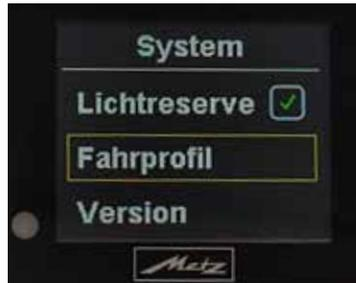
Entsprechendes Profil mit den Tasten 2 bzw. 3 anwählen. Bestätigen Sie die Auswahl durch Drücken der Taste 4. Sie verlassen automatisch das Untermenü "Fahrprofil" und gelangen wieder ins Systemmenü.
