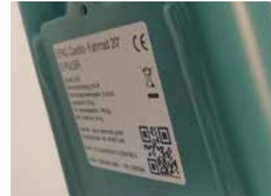
Notieren Sie sich wichtige Merkmale Ihres E-PULSRs und die FahrzeugIdentifikationsnummer (**FIN**) Diese steht auf dem Typenschild und ist zusätzlich unterhalb des Typenschildes in den Rahmen gestanzt. So kann Ihr Fahrrad bei Verlust einfacher beschrieben und identifiziert werden.
