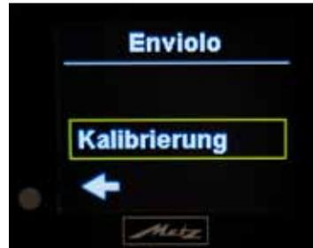
Um den Vorgang abzubrechen, wählen Sie mit den Tasten 2 und 3 den Rückspungspfeil an und Bestätigen dies mit der Taste 4. So gelangen Sie wieder ins "Hauptmenü". Oder Sie führen den Kalibriervorgang weiter fort, indem Sie den ausgewählten Menüpunkt "Kalibrierung" mit der Taste 4 bestätigen.
