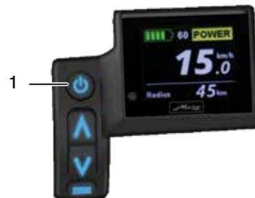
Sobald Sie den E-PACKR abstellen ohne das System auszuschalten, schalten sich das Cockpit und das elektrische System automatisch nach 20 Minuten ab.
