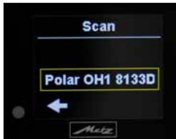
Falls Sie nicht mit dem angezeigten Gerät verbunden werden möchten, wählen Sie für einen Abbruch mit den **Tasten 2 / 3** den **"Rücksprungpfeil"** und bestätigen dies mit der **Taste 4**.
