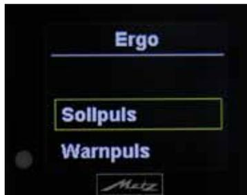
Mit den **Tasten 2 und 3** haben Sie nun die Möglichkeit einen Pulsschlag von **40/min** bis **240/min** in Einer-Schritten anzuwählen und mit der **Taste 4** zu bestätigen.
