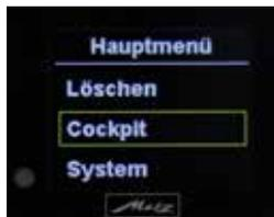
Zum Verlassen des jeweiligen Menüs (Haupt- oder Untermenü) muss entweder eine entsprechende Funktion bzw. Auswahl im Menü mit **Taste 4** bestätigt werden oder mit den **Tasten 2 oder 3** die Position "**Zurück**" ← angewählt und ebenfalls mit der **Taste 4** bestätigt werden.
