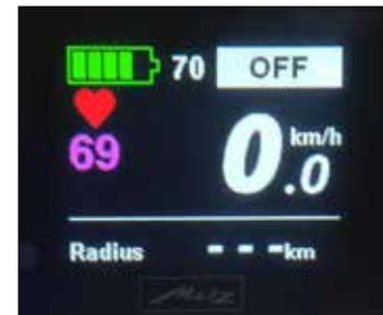
Hier: Wunsch-Kadenz **70** ; Unterstützungs-Modus "OFF" > Keine Unterstützung durch den Antrieb ; Herzschlag 69/min
