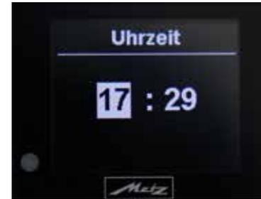
Die Anzeige, die Sie gerade einstellen können, ist jeweils weiß hinterlegt. Sie starten mit der Einstellung der Stundenanzeige. Stellen Sie mit der **Taste 2** oder **Taste 3** die Stunden vor oder zurück. Bestätigen Sie die Einstellung durch Drücken der **Taste 4**. Die Anzeige springt weiter zur Minuteneinstellung.
