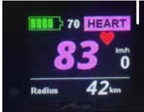
Reichweite kann sich stetig nach oben oder unten verändern, da abhängig von der aktuellen Motorunterstützung.
