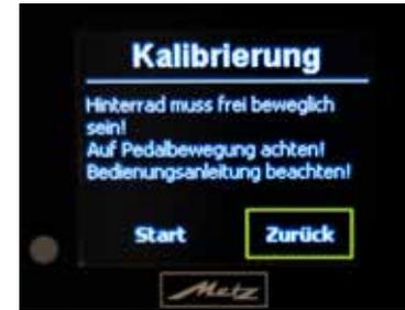
Hier haben Sie immer noch die Möglichkeit, die Funktion "Kalibrierung" abzubrechen, indem Sie mit den Tasten 2 und 3 das Feld "Zurück" anwählen und mit der Taste 4 bestätigen. Ansonsten bestätigen Sie mit der Taste 4 das "Start"-Feld.
