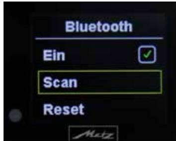
Danach startet das System die Suche nach koppel-fähigen Geräten. Wird ein zu koppelndes Gerät erkannt (hier Puls-Armband), so wird es im Display angezeigt. Wenn Sie mit dem angezeigten Gerät verbunden werden möchten, müssen Sie den angezeigten **"BT-Code"** mit der **Taste 4** bestätigen und gelangen automatisch wieder zurück ins Bluetooth-Menü.
