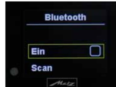
Damit das Gerät Bluetooth-Komponenten erkennt, muss der grüne Haken bei "**Ein**" gesetzt sein: Bestätigung mit **Taste 4**.
