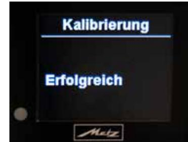
Um das Untermenü "**Kalibrierung**" wieder zu verlassen, muss im Anschluss die **Taste 3 oder 4** gedrückt werden.
