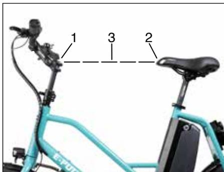
Um ein bequemes, ermüdungsfreies und sicheres Fahren zu ermöglichen, ist die Sattel- und Lenkerhöhe entsprechend der Körpergröße anzupassen.
