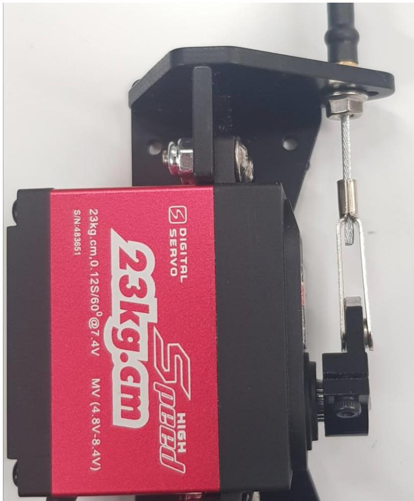
Das Stahlseil so Ablängen, dass es direkt in den beiliegenden M2-Gabelkopf eingelötet werden kann
