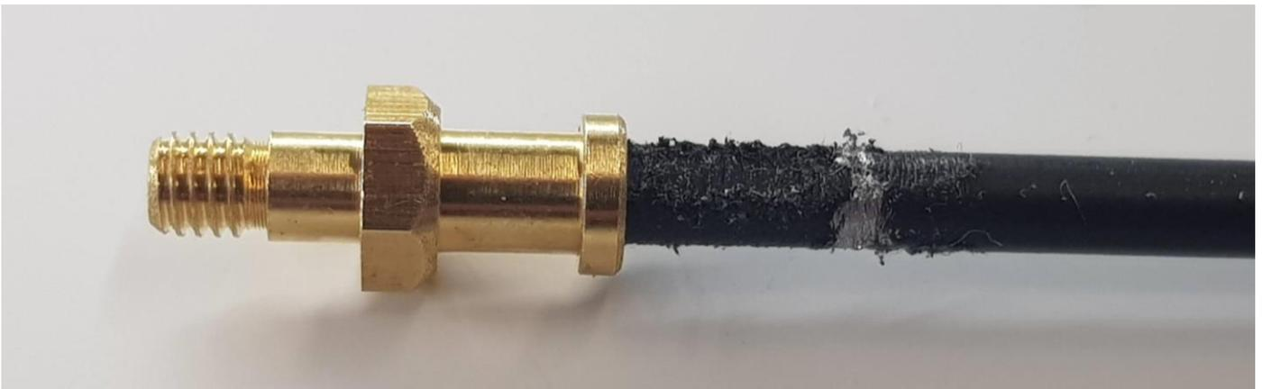
Den Schrumpfschlauch wie hier gezeigt (verkürzte Ausführung für das Bild) ganz aufschieben (das geht etwas streng) und unter Hitze schrumpfen. Hierbei verbindet sich der
