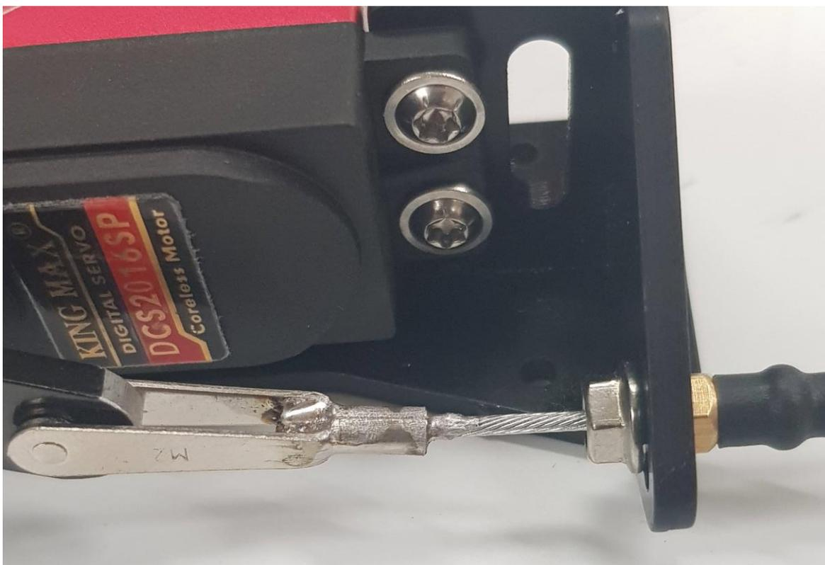
Das Widerlager läuft in einem Langloch, so dass je nach Servohöhe und Servohebel das Stahlseil in einer Flucht zum Gabelkopf läuft.
