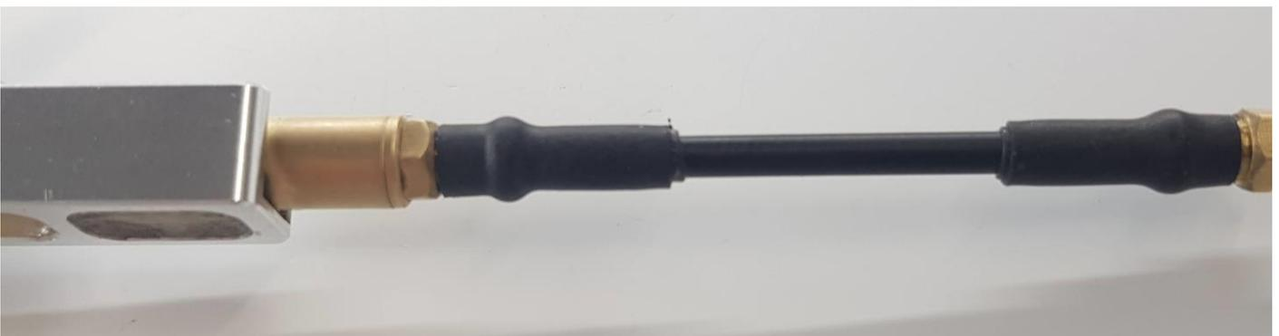
Kleber im Schrumpfschlauch mit der zuvor an geschmirgelten PVC-Haut des Bowdenzuges, was für eine stabile Verbindung sorgt
