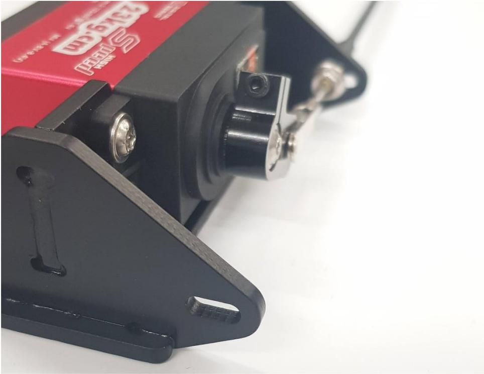
Die Servohalterung ist so gestaltet, dass man das Servo nach rechts oder links zeigen lassen kann, je nachdem wo das Servo seinen idealen Platz findet. Beide Seiten haben ein Widerlager mit Langloch.
