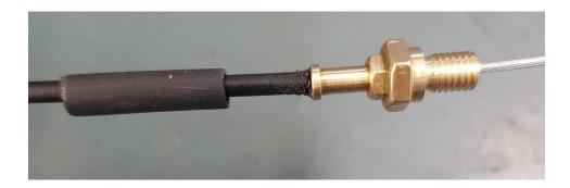
Nun wird der Schrumpfschlauch mit Heißluftfön oder Flamme geschrumpft.
