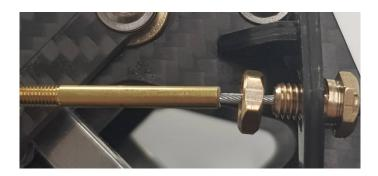
Nun kann das Messingstück mit der Mutter in dem Widerlager festgeschraubt werden. In dieser Position wird dann das Stahlseil in die Löthülse gelötet
