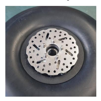
Das Rad mit der aufgesteckten Bremsscheibe und dem eingelegten Abstandshalter wird in die montierte Bremse eingeschoben, dabei muss man evtl. die Scheibe ein wenig anheben auf den Stiften.
