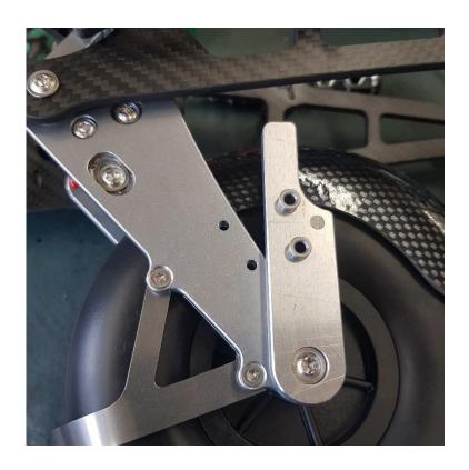
Anschließend müssen die beiden Löcher gesenkt werden, so dass die mitgelieferten Senkkopfschrauben M3 x 8 mm bündig abschließen.
