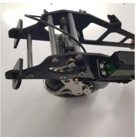
Dann wird der Bowdenzug am unteren Widerlager am Bremssattel abgeschraubt, indem die M3-Mutter auf der Seite der Rückstellfeder gelockert wird. Nun kann man den Bowdenzug komplett vom Stahlseil abziehen und mit einem Seitenschneider auf die zuvor markierte Länge abzwicken.
