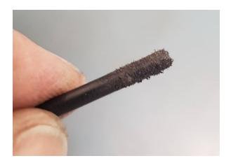
Das Stück Schrumpfschlauch (mit innen liegendem Kleber) wird **als erstes** auf den Bowdenzug aufgeschoben. Dann wird die zuvor aufgeraute PVC-Hülle mit einem Tropfen Sekundenkleber in das Widerlager geklebt. Die Hülle soweit es geht in das Widerlager schieben.
