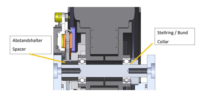
Der Abstand von 0,1 mm verhindert, dass der Abstandshalter eingeklemmt wird und das Rad sich nicht mehr drehen kann.
