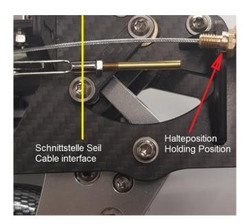
Das Stahlseil wird durch das obere Widerlager durchgeführt, die Mutter für das Messingstück auf das Seil geschoben und dann wird das Seil in die Löthülse eingeführt.
