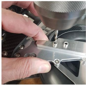
Es wird der mitgelieferte 3,0 mm Bohrer verwendet. Das Bohren des hochfesten Aluminium AW 7075 ist einigermaßen anspruchsvoll. Darauf achten, dass sich der Bohrer beim Austritt des Bohrers am Ende des jeweiligen Lochs nicht in das Material zieht.
