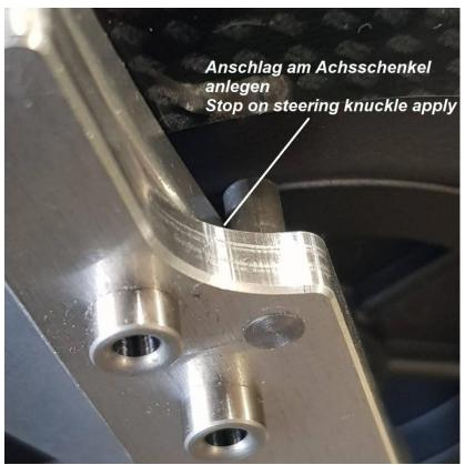
Die Bohrbuchsen sind gehärtet und gewährleisten eine sichere Führung des Bohrers.
