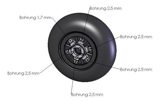
Der Mitnehmer wird auf eine Seite der Kunststofffelge des Rades aufgesetzt, so dass dieser an den Speichen der Felge einrastet. Dieses Einrasten verhindert auch das Drehen des Mitnehmers auf der Felge.
