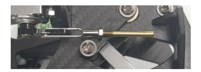
Zum Ablängen des Stahlseils wird dieses zuerst mal mit dem Messinglager an der Außenseite an das Widerlager gehalten und das Stahlseil wie gezeigt abgelängt. Da kommt es nicht auf den mm an, das Seil sollte nur nicht durch den Gabelkopf durch gehen.
