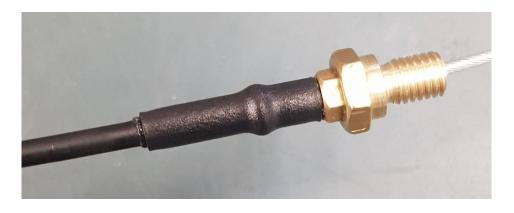
Der abgelängte Bowdenzug wird wieder auf das Stahlseil geschoben und am unteren Widerlager der Scheibenbremse montiert, die M3-Sicherungsmutter auf der Seite der Rückstellfeder wird fest angezogen.
