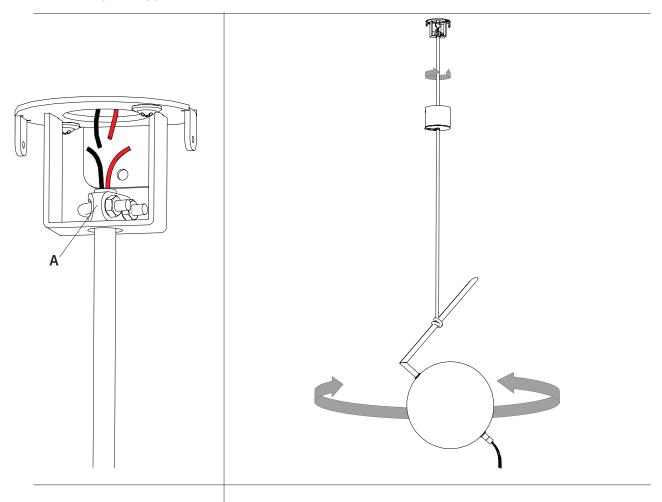
5 - LOCK THE PENDANT CABLE IN POSITION WITH THE CABLE BLOCKER (A) PROVIDED.
