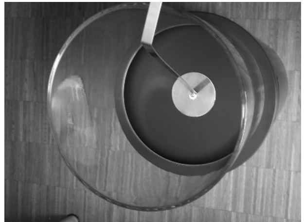
Abb.2: Brenner geschlossen, Löschstempel verdeckt die Brenneröffnung (Symbolische Darstellung)
