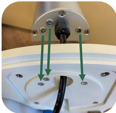
Befestige die LED mit den drei mitgelieferten langen M4 Schrauben an die Deckplatte.
