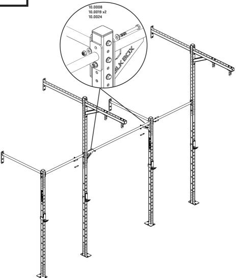
TIGHTEN ALL BOLT ASSEMBLIES WITHIN THE ELLIPSES TO THE 30Nm TORQUE . ENSURE UPRIGHTS ARE PLUMB. DRILL AND SECURE UPRIGHTS, 1.2 BOX WM (21-0434) AND 1.2 `SINGLE BAR WM (21-0126) AS SHOWN IN GUIDE.
