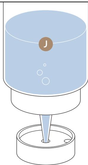
8. Mettez les embouts à l'envers et utilisez la solution de nettoyage (**J**) pour rincer tous les embouts de traitement en insérant la buse dans les orifices de l'embout jusqu'à ce que la solution de nettoyage sorte par l'autre extrémité.
