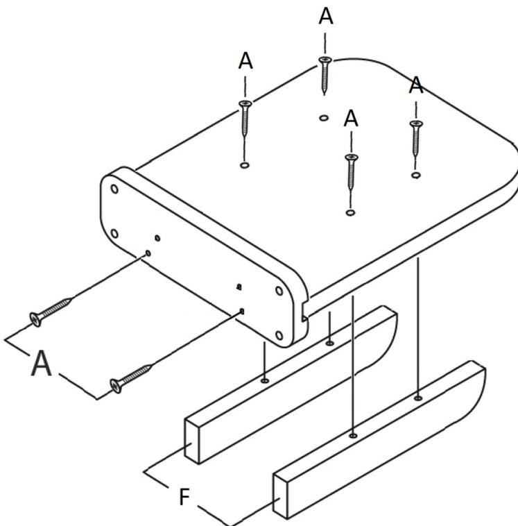
Connectez ici les pièces "F" à la plaque "D" et la pièce "G" avec les vis "A".
