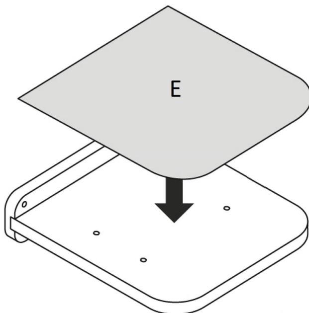
In questo passaggio puoi incollare il tappetino "E" al pannello "D". Non dimenticare di rimuovere la pellicola del nastro adesivo biadesivo.
