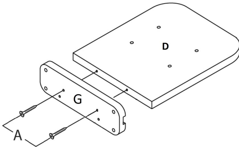
Connectez ici la pièce "G" à la plaque "D" à l'aide des vis "A".
