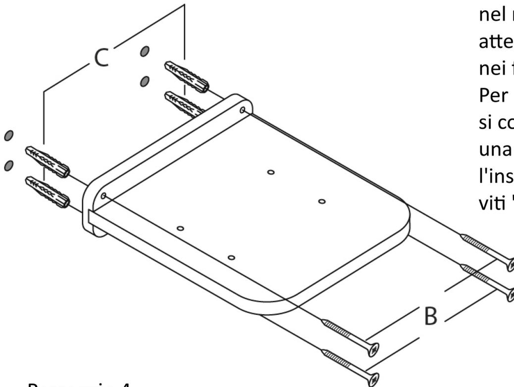
Praticare i fori necessari nel muro e inserire con attenzione i tasselli "C" nei fori con un martello. Per i migliori risultati, si consiglia di utilizzare una livella. Quindi fissare l'insieme al muro con le viti "B".
