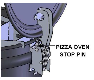
INSERT PIZZA OVEN STOP PIN INTO TOP HOLE ON HINGE
