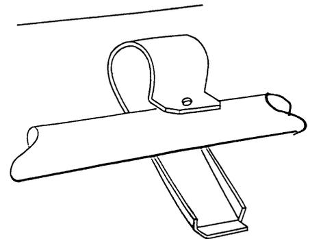
Schraube in 6-Kant-Nuss im Schrauber einstecken. Mit Schrauber nach unten drücken ohne zu drehen bis Schraubenspitze das untere Loch erreicht
