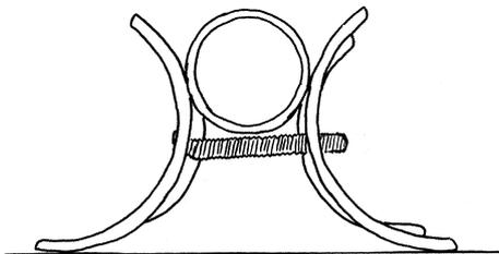
Mittels der mitgelieferten Schraube, welche unter dem Schneefangrohr die beiden Hälften verbindet, werden diese zusammengeschraubt.
