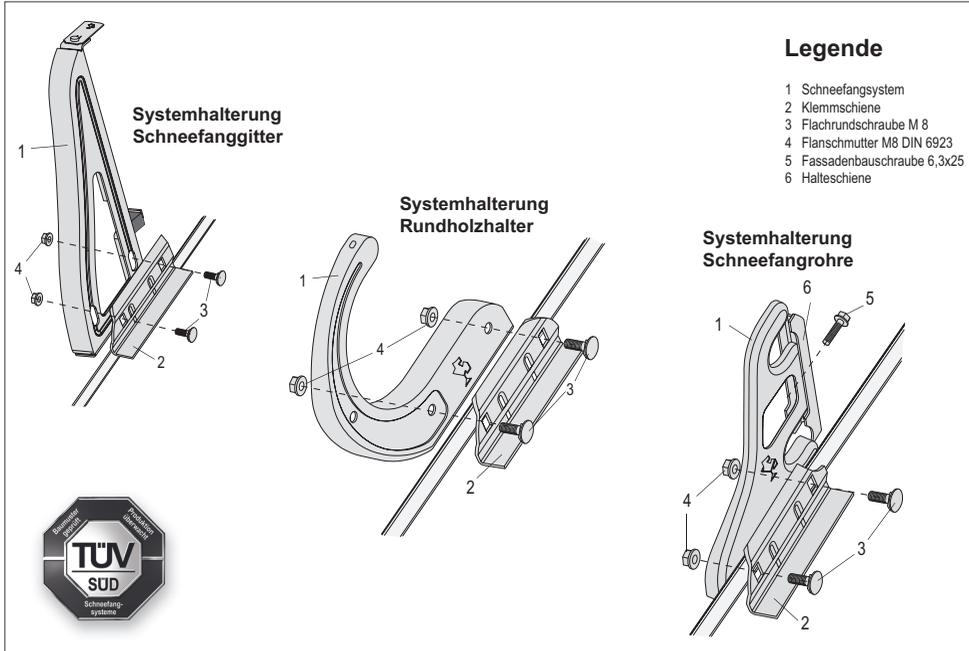
Die Schneefangsysteme können sowohl am rechts- bzw. linksgefalteten Doppelstehfalz montiert werden. Die Klemmwirkung wird dadurch nicht beeinträchtigt.
