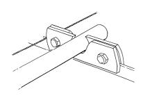
Zum Anbringen der Schneefangreihe sind jeweils am Dachrand-Ortgang links und rechts Schneefanglaschen zu setzen. Diese sind mit einer Schnur, welche als Hilfe zur geraden Montage dient, zu verbinden.
