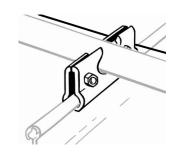
Zur Montage sind die Schneefanglaschen mit der Kröpfung nach innen waagerecht unter das Schneefangrohr zu legen. Anschließend werden diese hochgeklappt und die Schrauben eingesetzt. Schraube festhalten, Mutter anziehen und Schneefanglasche nach dem Schnurschlag ausrichten.
