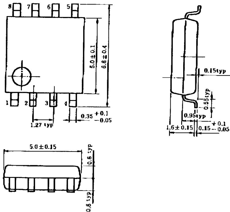
■ 8-PIN PLASTIC DIL PACKAGE (EXTERNAL VIEW) (UNIT : mm)
