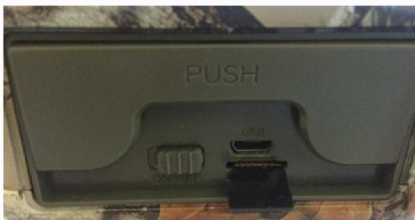
3. Mettez l'interrupteur sur la position "ON", et le témoin lumineux clignotera 3 fois avant de s'éteindre, la caméra entrera en mode de détection PIR.
