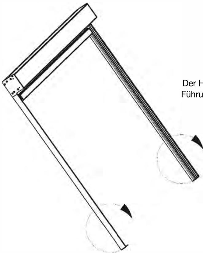
Der Hauptrahmen wird manuell von zwei Führungsschienen gehalten.
