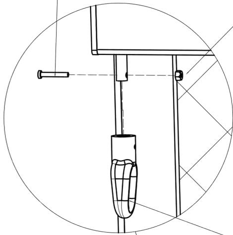
Setzen Sie den Scharnerring in die Getriebewelle ein
