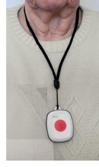
Die im Lieferumfang enthaltene Batterie der NOBU GO-Kette hat eine Lebensdauer von etwa vier Jahren und ist einfach austauschbar. Dies gewährleistet eine zuverlässige Notrufbereitschaft über einen längeren Zeitraum, ohne häufige Batteriewechsel. Damit die NOBU GO-Kette ordnungsgemäß funktioniert, sind bestimmte Mindestanforderungen erforderlich. Sie kann mit dem Funkempfänger NAVI GO oder dem IQcare SAFEhome Hausnotrufsystem verwendet werden.
