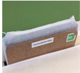
Die Einschubhilfen einzeln etwas zurückziehen und den Rest der Sensoreinheit komplett einschieben.
