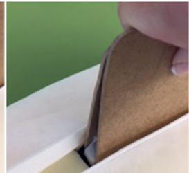
Die Einschubhilfen vorsichtig einzeln rausziehen. Die Sensoreinheiten befinden sich jetzt richtig positioniert in der Matratze. Vliesbezug und Matratzenbezug wieder schließen.
