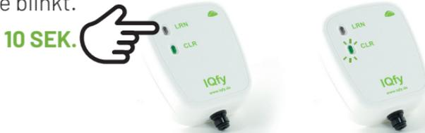
Die CLR Taste ca. 3 Sekunden drücken, bis das Licht kurz ausgeht, bevor es wieder grün blinkt. Der Funkempfänger befindet sich jetzt wieder im Auslieferungszustand und kann entsprechend der Bedienungsanleitung neu angelernt werden.
