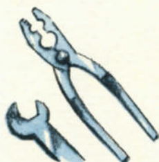
Flachzange zum Blechbiegen ersetzt nicht den Schraubenschlüssel
