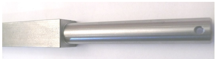
Achse verbessert, Achszapfen angedreht
