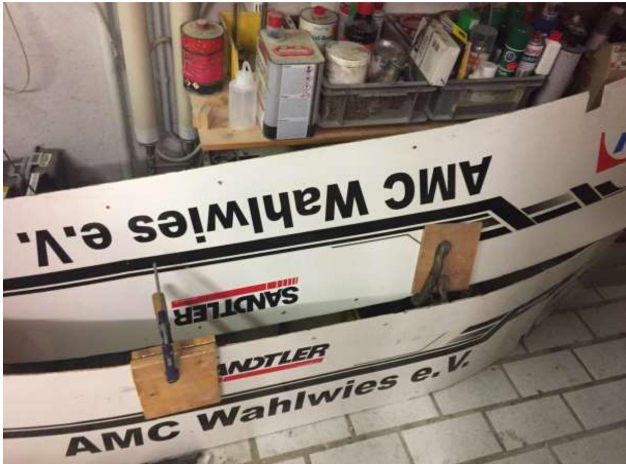
Die ausgeleiteten / renovierten Seitenteile geparkt, damit die Verleimung auch genügend ausgehärtet ist, wenn die Seitenplatten weiter verarbeitet werden. Diese werden durch die neuen Rundungen / Geometrien schon beansprucht.
