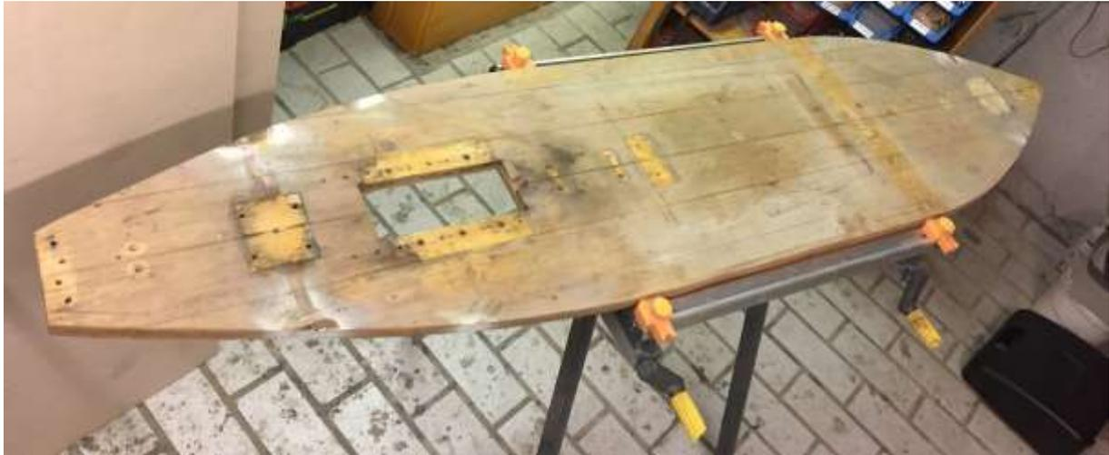
Die von Bauteilen befreite Bodenplatte. Man kann auch erkennen, dass die Form nicht Regelkonform ist. Die Norm schreibt vor, dass der hintere Teil einem Dreieck gleichen soll. Hier ist diese bogenförmig ausgeführt (rechte Seite im Bild).
