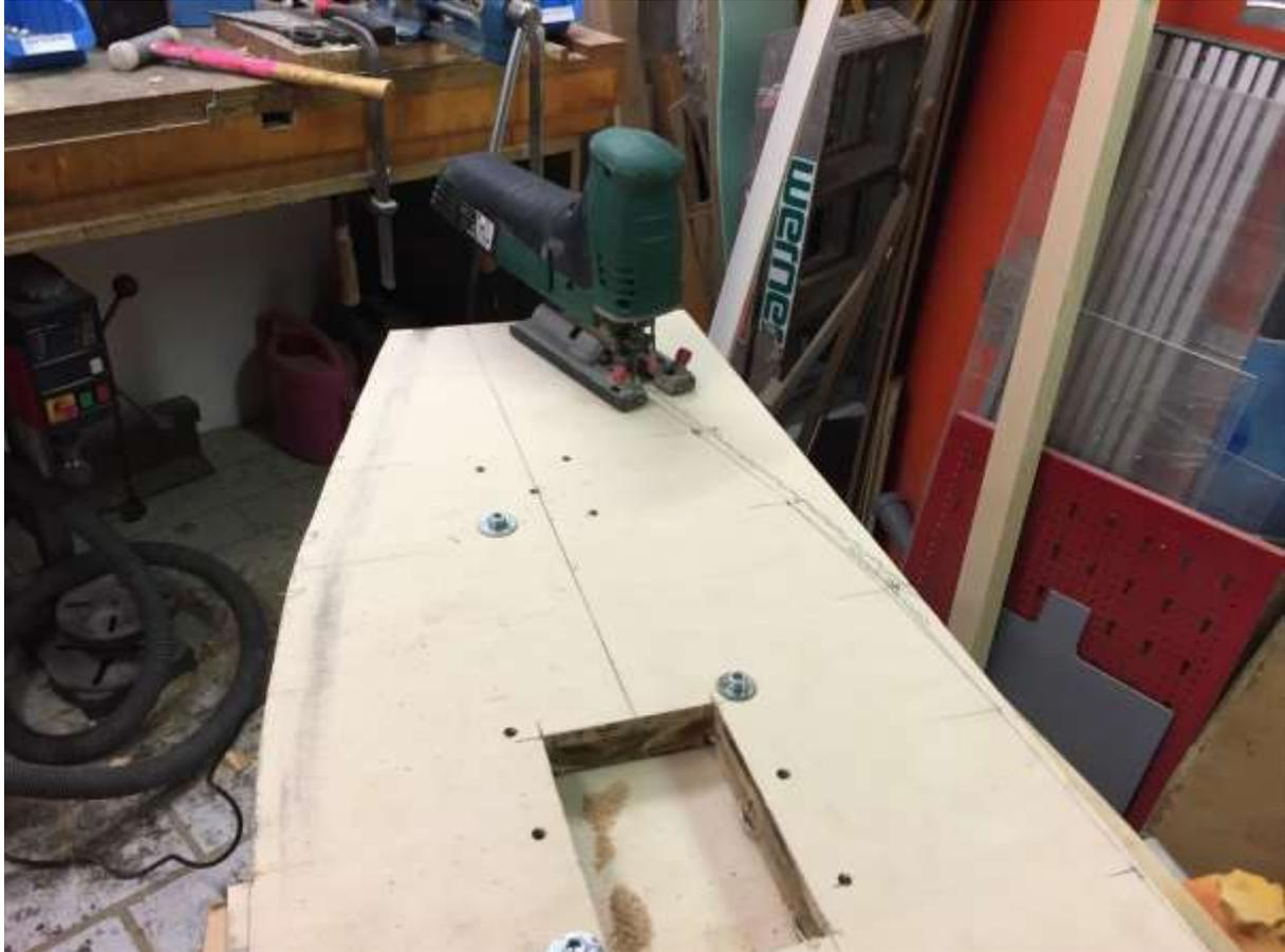
Die obere Platte hat ja schon die Durchgangslöcher zu den Gewindebuchsen, daher kann diese mit dieser Verbindung verschraubt werden.
