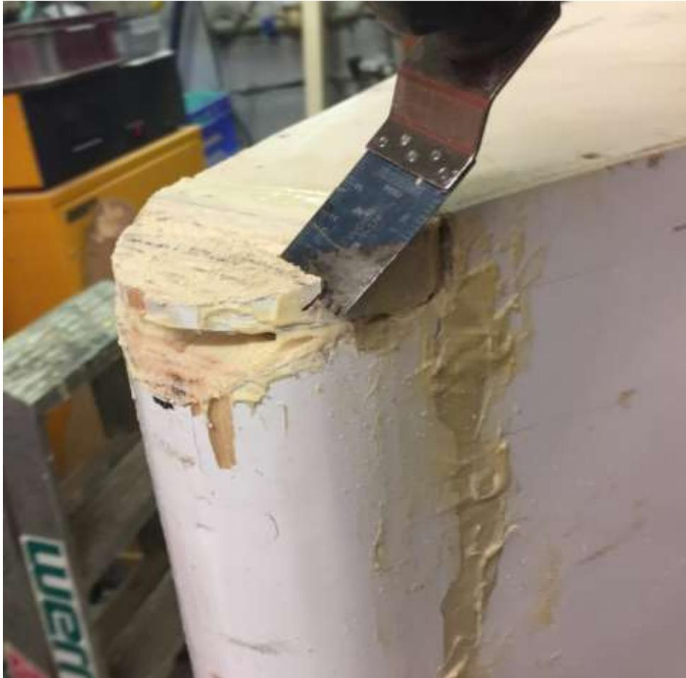
Ich hab das wie überlagerte Keile, Ebene für Ebene abgeschnitten und anschließend mit dem Bandschleifer die Kanten verrundet.
