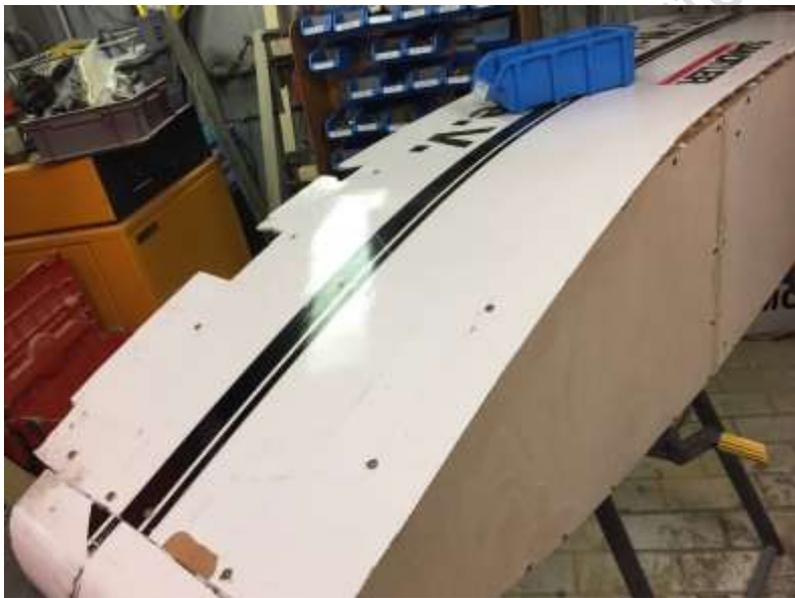
Ich habe vorn am Stoß zum Bug angefangen die Platte zu fixieren. Damit diese in um die X Achse (Längs) verrutscht, wurde auch hinten eine Spax gesetzt. Dann wurde vom Bug zum Heck gearbeitet, immer 2, 3 Schrauben oben, 2,3 Schrauben unten.
