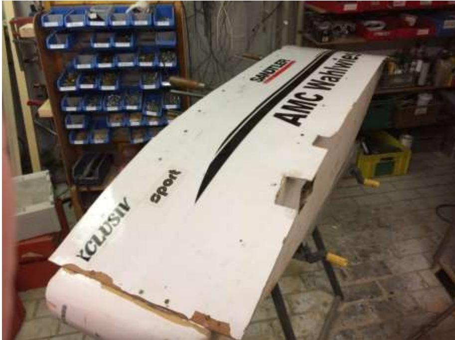
Die Stellen, welche schon etwas brüchig waren, erhielten mehr Schrauben, so dass sicher gestellt ist, dass das Seitenteil auch gut mit den Platten verleimt ist.
