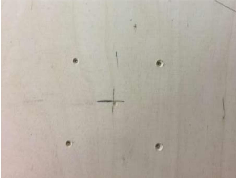
Auch die Position der Ausnehmung vom Bremsstempel wurde übertragen. Da es ein Loch war, ist es einfach mit Bleistift markiert worden.
