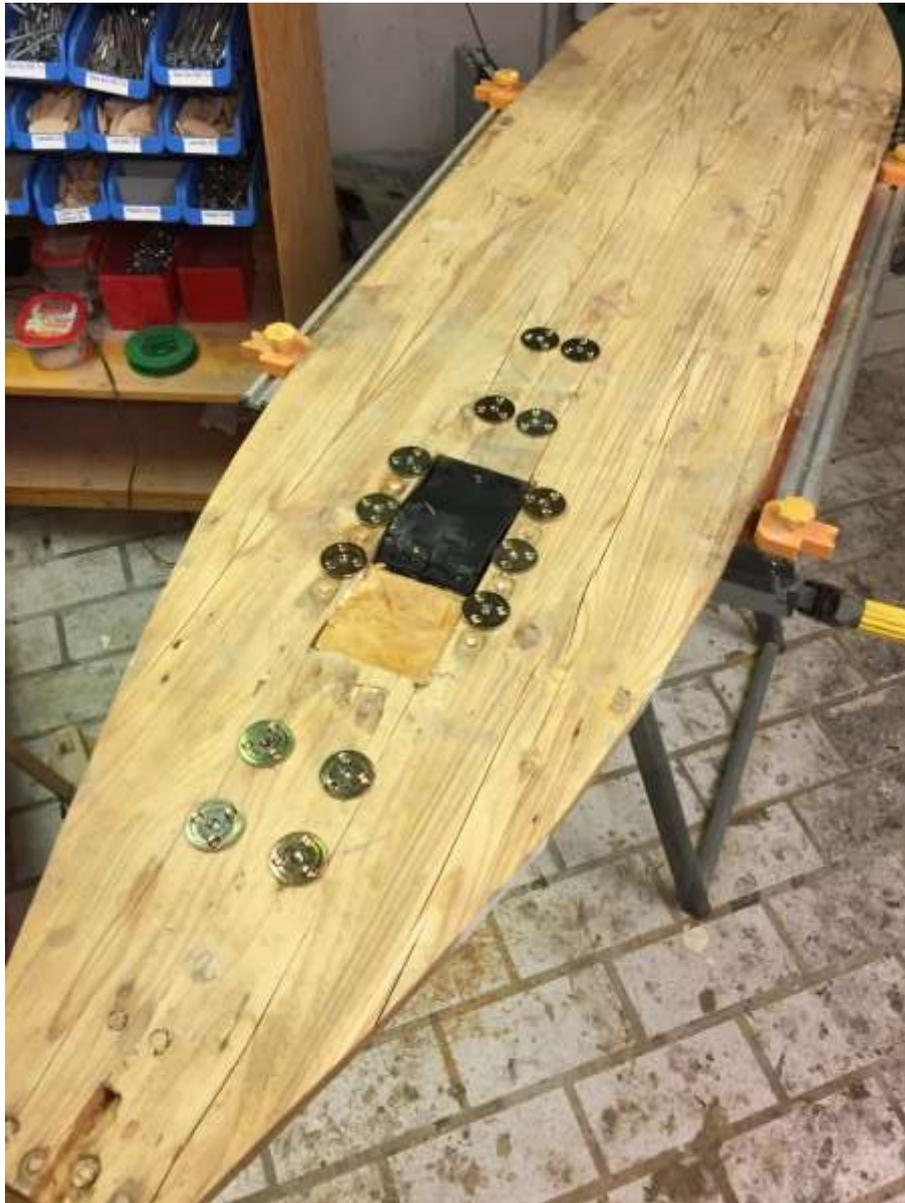
Da die Durchgangslöcher teilweise ausgeleiert und auch teilweise schräg eingebracht wurden, habe ich erst mal mit einem 7er Bohrer die Löcher korrigiert. Als Schablone dienten die Original Bauteile. Danach wurden die Bohrungen auf 12mm aufgeweitet. Die Löcher waren jetzt passgenau. Der Beschlag konnte mit „handwarmer“ Kraft eingedrückt werden.
