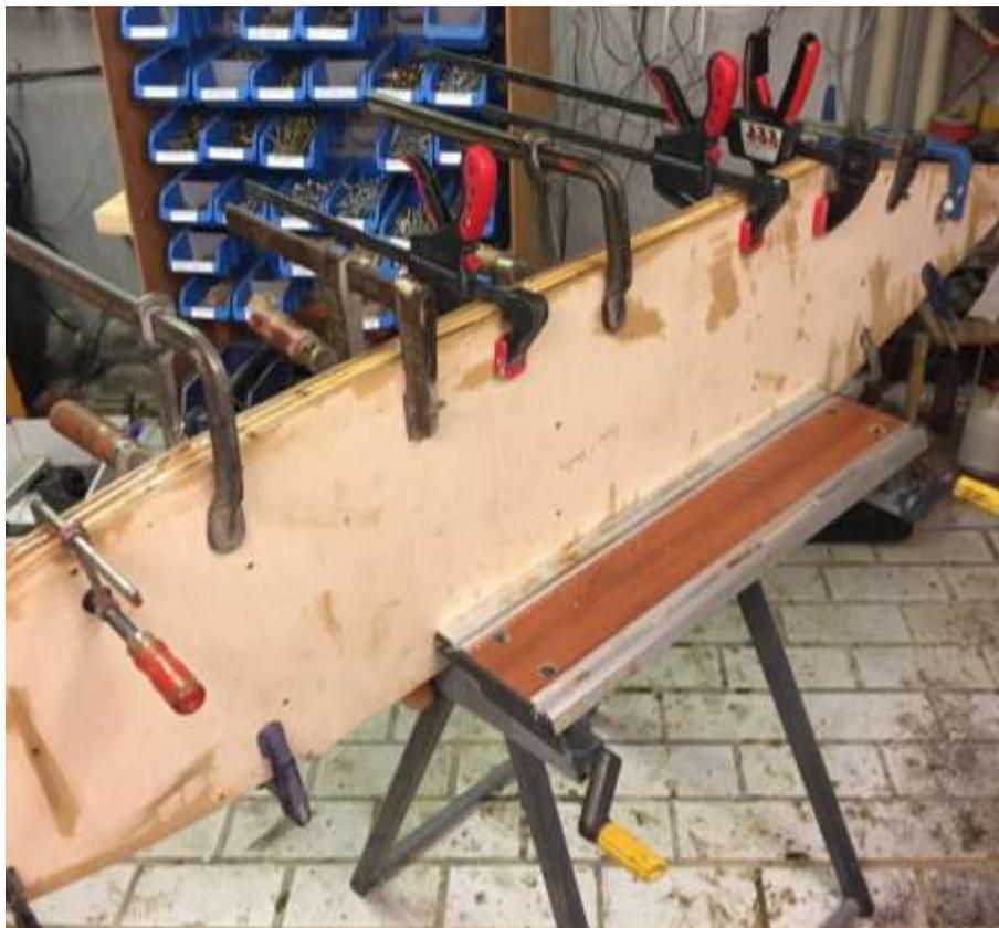
Detailbild zeigt das Bodenbrett von unten. Man sieht die Schrauben, welche dafür sorgen, dass auch in der Mitte gleichmäßig verleimt wird und es keinen Bauch gibt. Im oberen Brett haben wir ja dafür die Inbusschrauben. Die in der unteren Bodenplatte versenkten Spaxschrauben bleiben einfach drin. Da die wahrscheinlich mit Harz umantelt sind, bekommt man die eh nicht raus.
