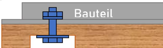
Grundsätzlich verbessert die versenkte Methode die Verletzungs- / Beschädigungsgefahr. Man muss aber dabei bedenken, dass wenn man das Holz dünn ausführt (z. B. das Standardholzbrett mit 21 mm) schwächt man an der Stelle die
