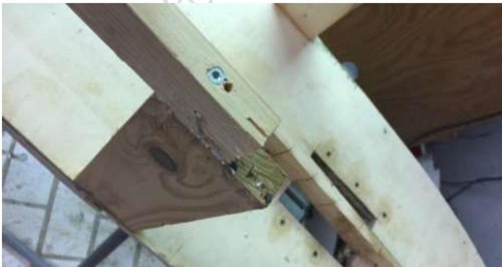
Das Bild zeigt den Stoß zum Bogenstück des vorderen Teiles. Dank der breiten Spanten kann man den jetzt geteilten Obergurt gut verbinden.
