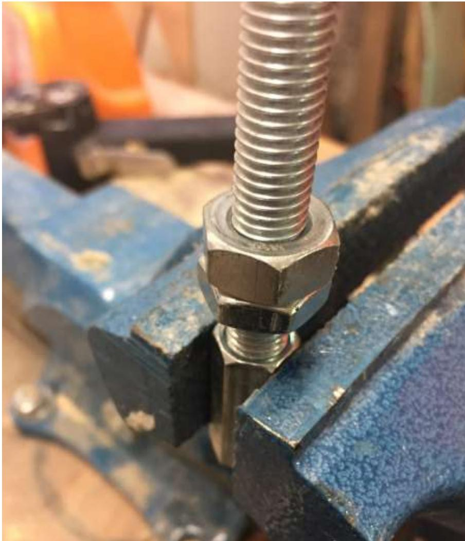
Damit sich die Gewindestange kontern lässt, hab ich zuerst 2 Muttern gekontert, damit hab ich quasi einen Antrieb geschaffen. Dann die Schrauben gegen den Gewindeeinsatz angezogen. Anschließend die Konterschrauben gelöst. Jetzt mussten die Muttern den langen weg zurück raus gedreht werden. Dass das schnell von statten ging, hab ich kurzer Hand die Gewindestange in den Akkuschrauber einspannt. Damit sind die Schrauben geradezu rausgeflogen.
