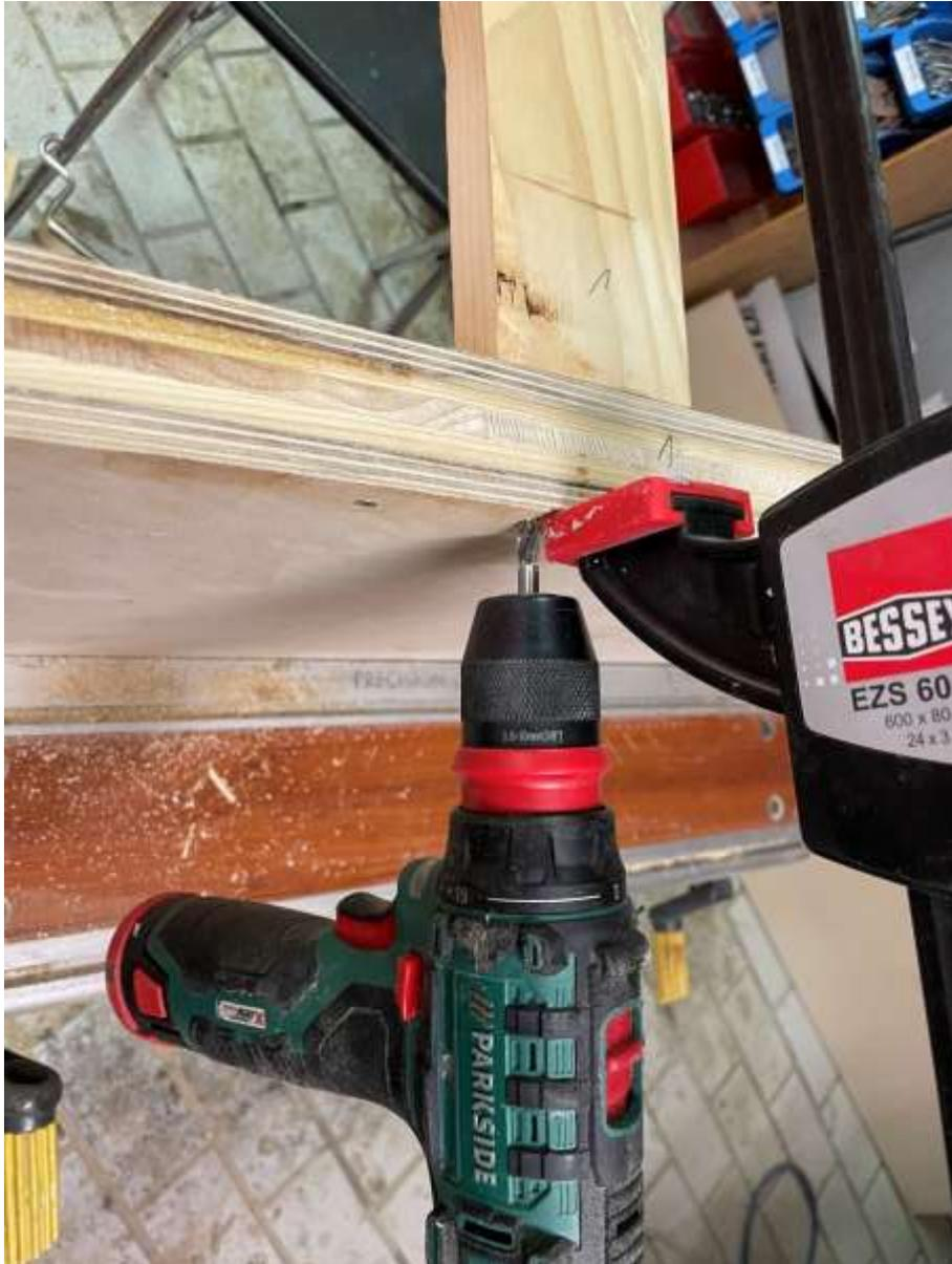
Die Spanten wurden gezeichnet und festgedübelt. Gedübelt deshalb, da ganz zum Schluss mit einem Abrund-Fräser die Kiste eine gleichmäßige Rundung erhalten soll. Und da stören die Schrauben.
