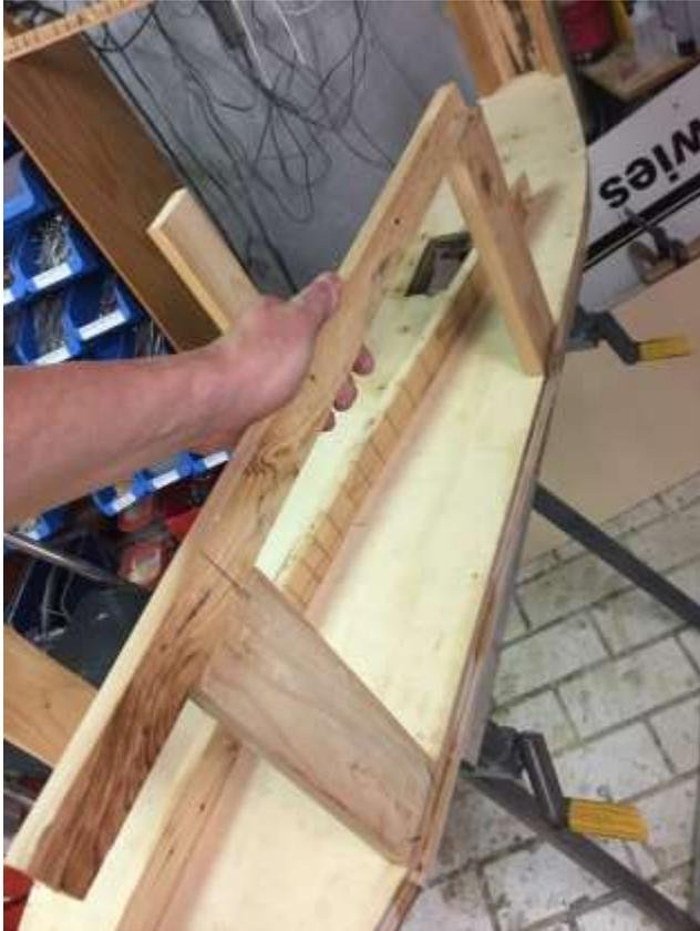
Da viele krumme und verbogene Bauteile weiter verwendet werden sollen, mussten zuerst die maßhaltigen Bauteile verarbeitet werden, danach wurden die gebrauchten Teile nach den geraden Bauteilen gerichtet.
