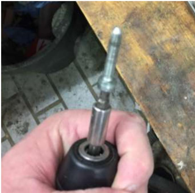
Spitz geschliffene Inbus Schraube
