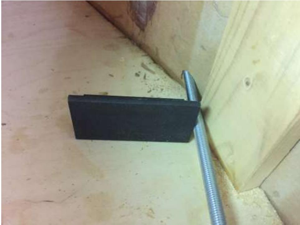
Diese musste jetzt in Form gebracht werden. Dazu wurde wieder der Winkelschleifer angeworfen und das Stück Stahl geformt. Ein paar Löcher noch und fertig war der Gegenhalter. Und da aus 8mm Winkelstahl gefertigt, hält der auch. Da dieser Winkel viel Energie ableiten muss wurde an Befestigungsschrauben nicht gespart.
