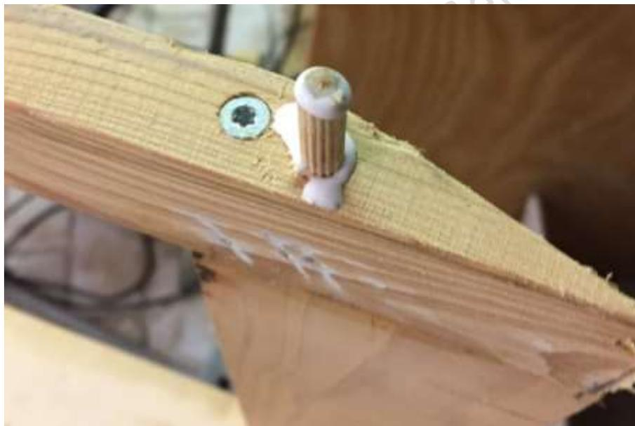
Zuvor wurden die Spaxschrauben durch Dübelverbindungen ersetzt.
