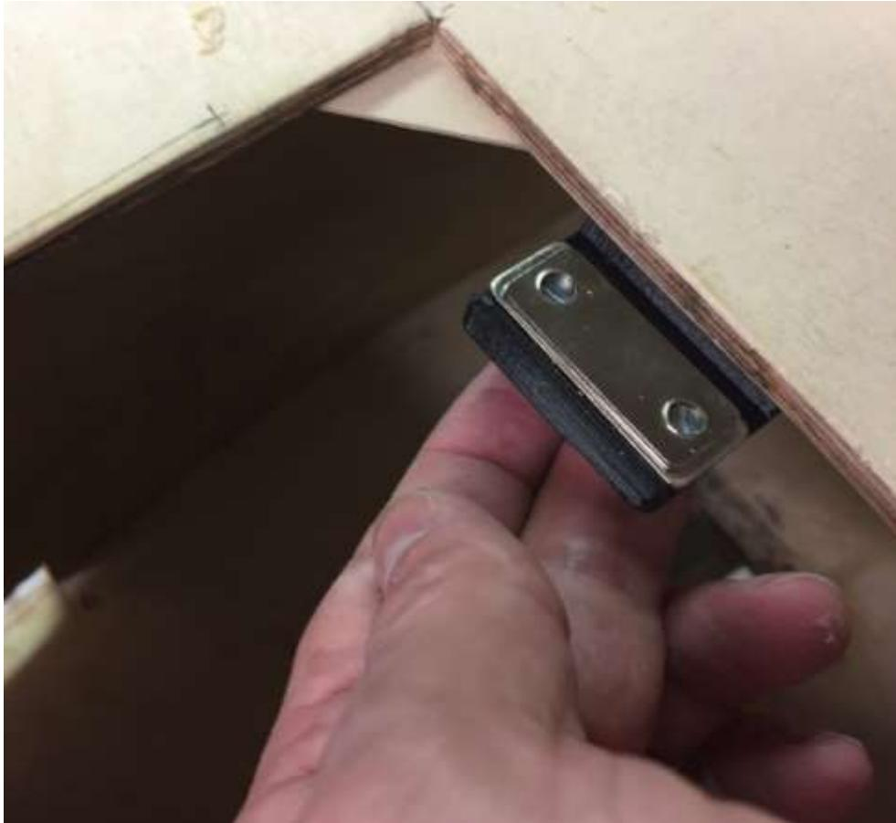
Die überstehenden Schrauben hab ich einfach mit dem Winkelschleifer abgeschnitten.
