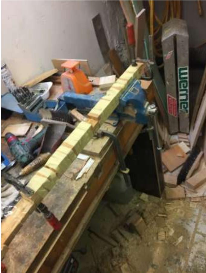
Nachdem der Leim trocken ist, sind die Holzleisten zwar nicht wie neu, aber brauchbar, da diese ja an der Seitenwand und Deckplatte verleimt werden.
