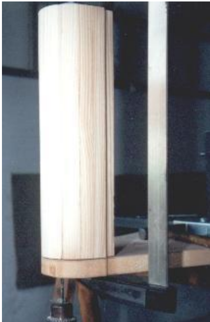
Befestigen der Bugaussteifung auf der Bodenplatte
