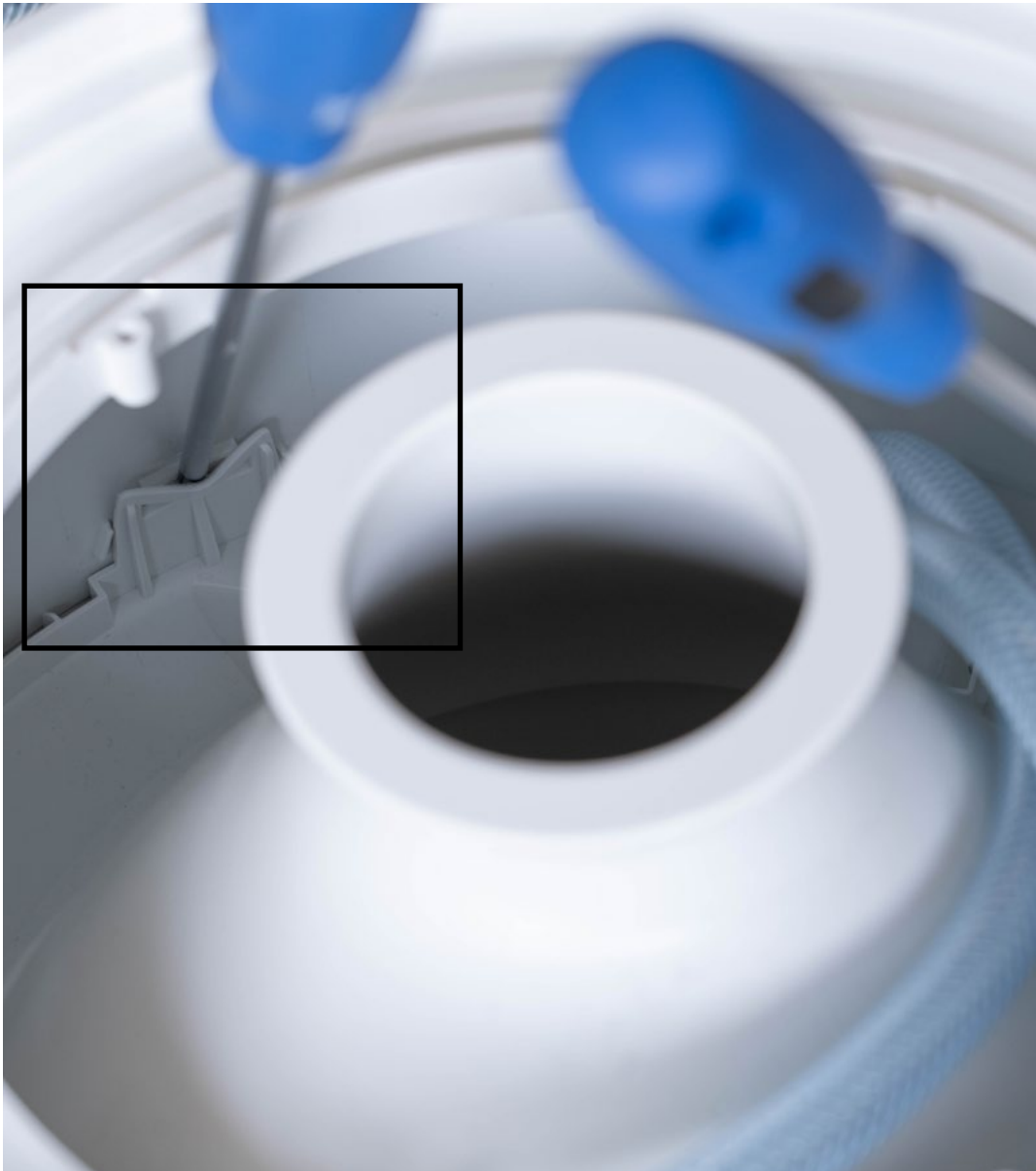
Abb. 12: Schraubenzieher an hinteren Einrastverschlüssen ansetzen
