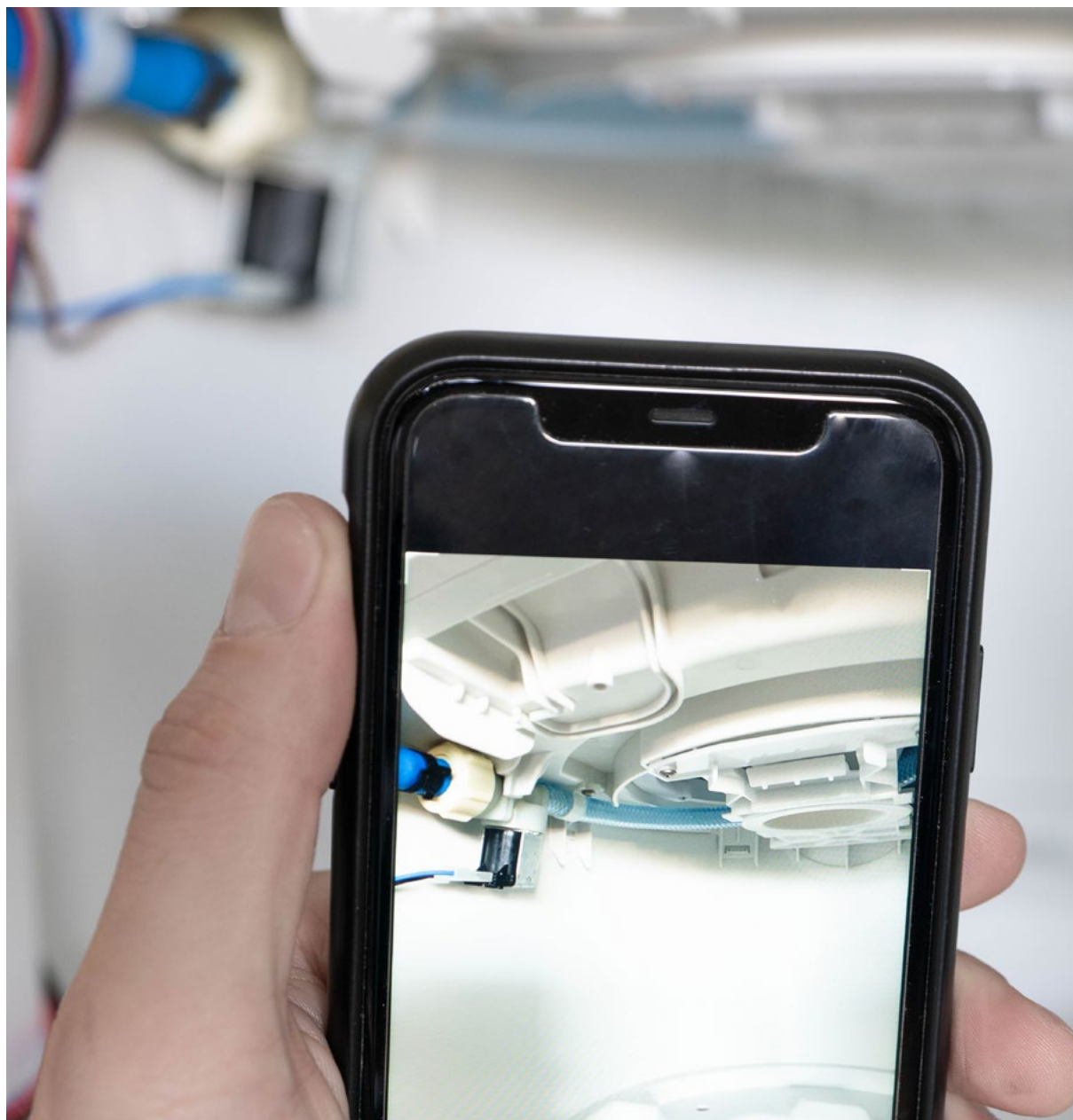
Abb. 3: Originalzustand im Gehäuse fotografieren
