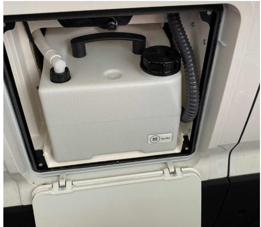
Abb. 26: Fertiger Einbau mit verbundenem Urinschlauch
