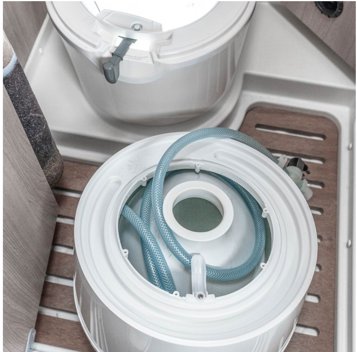
Abb. 11: gelöster WC-Schüssel Rahmen inkl. Schlauch und Pumpe
