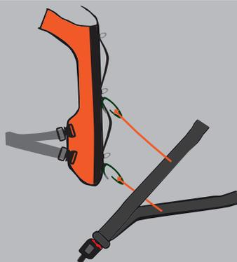
2. Accrochez les deux mousquetons à la ceinture de sécurité. Le mousqueton avant est accroché à la partie supérieure de la ceinture de sécurité et le mousqueton arrière à la partie inférieure
