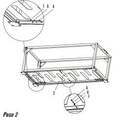
Ensamble los dos juegos de patas con el estante inferior (2) utilizando tornillos hexagonales M6\*12 mm (A), arandelas D6 (I) y arandelas de resorte M6 (G) en el interior.
