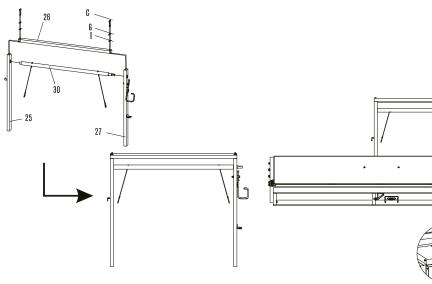
Paso 5 Montar el sistema de elevación. Con tornillos hexagonales M6\*50 (C), arandelas de resorte M6 (G) y arandelas D6 (I)
