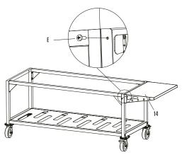
Ensamble la mesa auxiliar (14) con el juego de patas izquierda (3) usando tornillos M8\*16mm (E).
