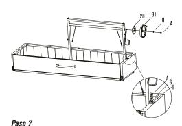
Inserte el engranaje (28) y la manivela en el sistema de elevación, fíjelo con una arandela D6\*20 (0) y un tornillo hexagonal M6\*12 (A) Fíjelo en el cuerpo principal con dos tornillos hexagonales M6\*12 (A), arandelas de resorte D6 (G) y arandelas D6 (I)
