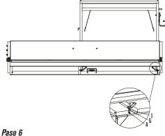
Fije el sistema de elevación en el cuerpo principal usando tornillos M6\*12 (A), arandelas de resorte M6 (G) y arandelas D6 (I).
