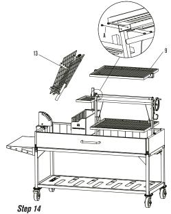
Inserte la cesta para asar (13) en la base de la rejilla de sujeción. Coloque la parrilla de calentamiento superior en la parte superior de la barra superior del sistema de elevación, fíjela con tornillos hexagonales M6\*12 mm (A).
