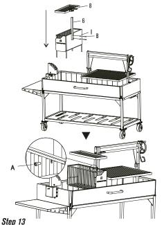
Coloque el brasero (5) al lado de la parrilla principal. Fije la barra de soporte (6) con tornillos hexagonales M6\*40 mm (B) y arandelas D6 (I). Inserte la parrilla secundaria (8) en la barra de soporte ensamblada (6) y fíjela con el tornillo de anillo (M). Atornillar el brasero con la varilla izquierda del sistema de elevación.
