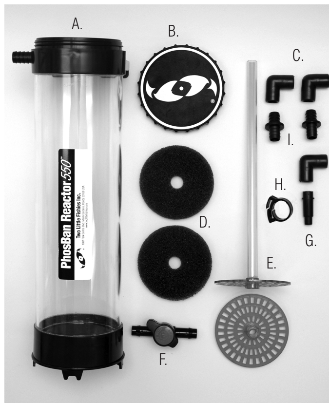
A. Reactor body; B. Lid (Qty: 1); C. soft 90 fitting (Qty: 3); D. Sponges (Qty: 2); E. Dispersion Plate (Qty: 2); F. Ball valve (Qty: 1); G. short pipe adaptor (Qty: 1); H. Ratchet Clip (Qty: 1); I. Connectors (Qty: 2).
