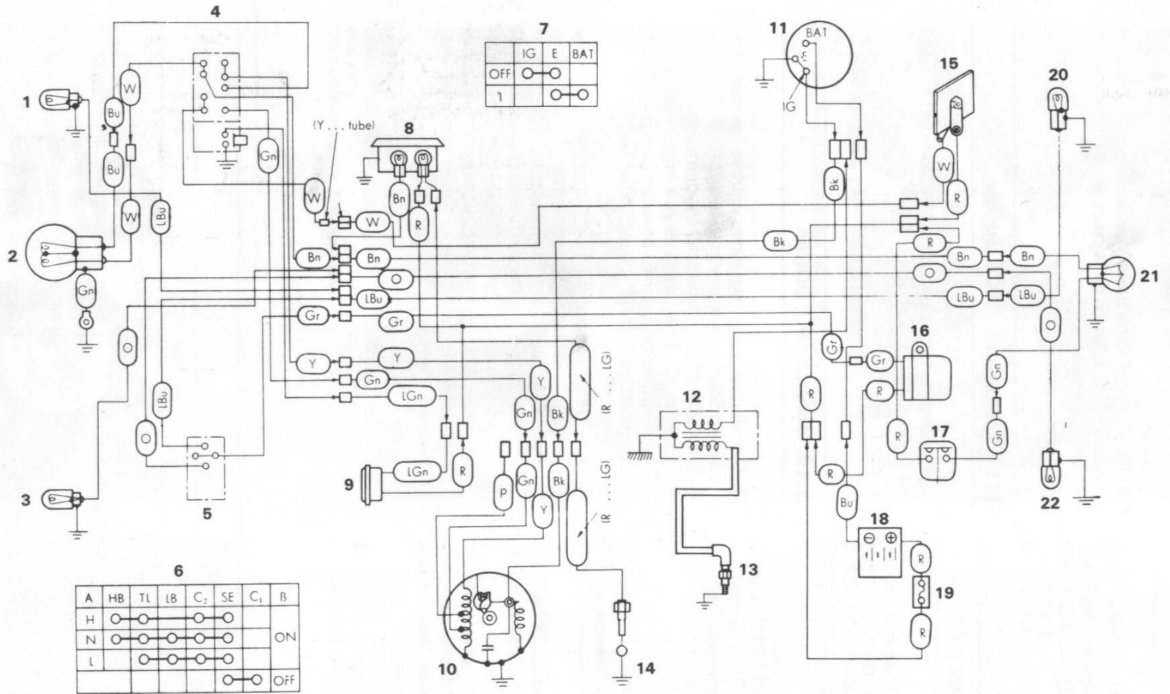
**Bild 270 Verdrahtungsschema C50**
