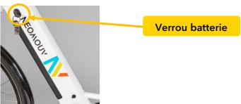
Pour remettre la batterie, commencer par positionner correctement le bas puis rebasculer la batterie dans son logement.
