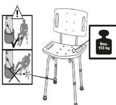
10. Richten Sie die Gummifüße so aus, dass der Duschhocker mit Rückenlehne einen festen und sicheren Stand hat.
