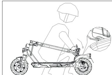
Heben Sie das Rad nach dem Zusammenklappen an, während Sie den Lenkervorbau mit einer oder beiden Händen festhalten.
