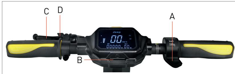
Pospoševalnik (A): pritisnite navzdol, da pospešite.
