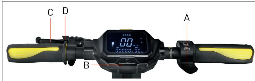
Gaspedal (A): Zum Beschleunigen nach unten drücken.
