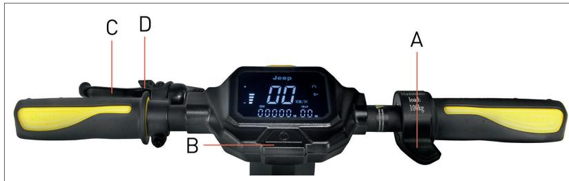
Acelerador (A): presionar hacia abajo para acelerar.
