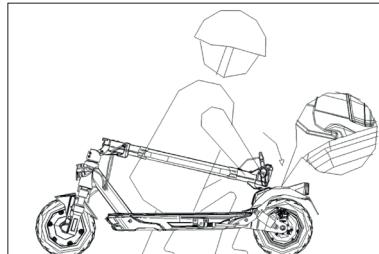
Na het inklappen tilt u de stuurpen op terwijl u deze met één of beide handen vasthoudt.
