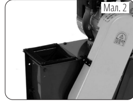
Прилаштування прокладки бункера
