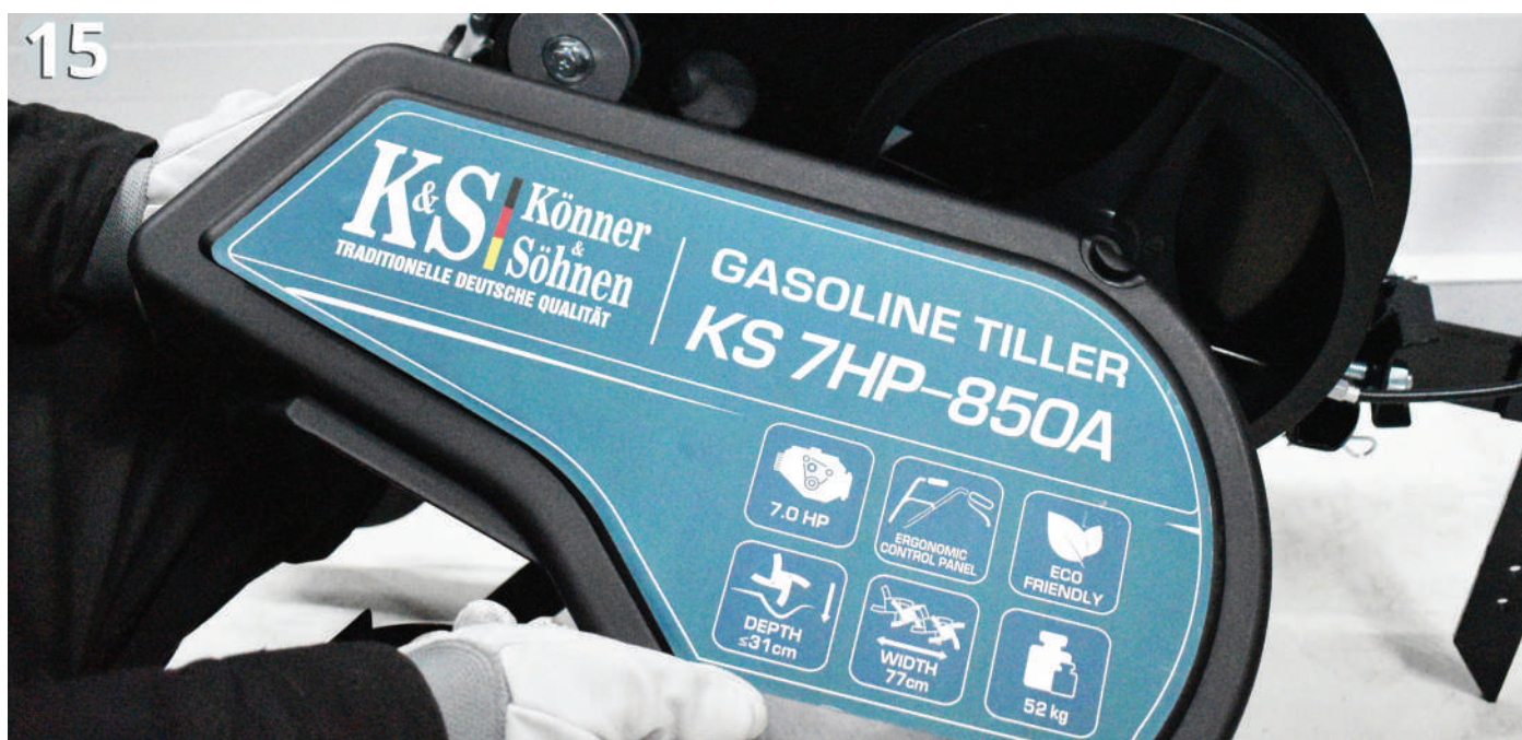
Мал.15. Встановлення захисного кожуха на корпус культиватора.
