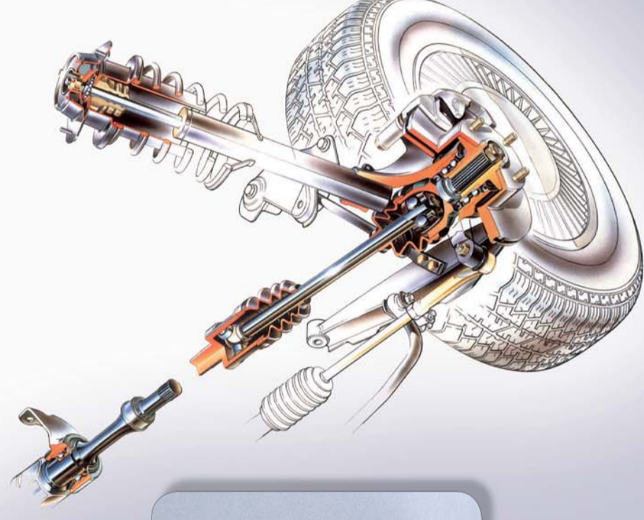
Rolamento de Roda 1ª Geração - HUB I Rolamento de duas carreiras de esferas de contato angular
