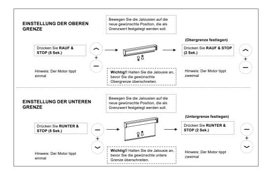
WARNUNG! - Steuern Sie die Jalousie in kurzen Schritten, indem Sie die AUF/AB-Taste in 1-Sekunden-Intervallen drücken (wenn Sie die AUF/AB-Taste länger als 3 Sekunden drücken, kann die Jalousie den gewünschten oberen/unteren Grenzwert überschreiten, was zu Schäden am Produkt führen kann). Sobald Sie den gewünschten oberen/unteren Grenzwert erreicht haben, könnten Sie den Grenzwert mit den Tasten AUF oder AB einstellen. Denken Sie daran, in kurzen Schritten einzustellen!
