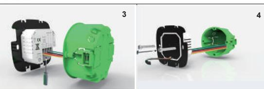
Étape 5. Fixez le corps du thermostat et la plaque de montage par rotation.
