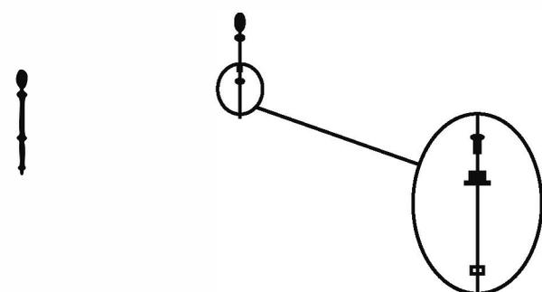
Étape 5 : Vissez les anneaux (7) aux clips de montage que sont les vis M4 8mm (4) et les écrous (8).
