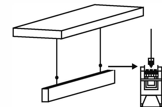
Étape 7 : Fixez l'étrier de fixation à l'arrière du luminaires.
