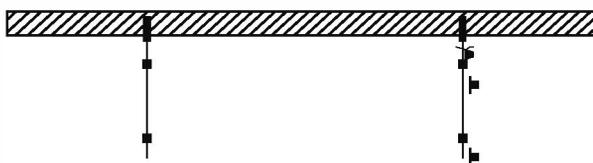
Étape 4 : Faites passer le câble de suspension (9) dans les capuchons de montage (3). Passez ensuite le câble dans les supports de verrouillage du câble (6). Le câble devra sortir par l'ouverture latérale des supports pour câble (2).
