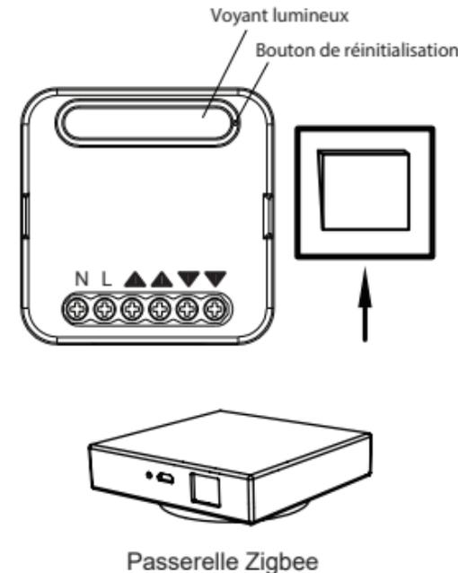
Une fois le câblage du module terminé, appuyez 5 fois sur la touche de réinitialisation ou allumez/éteignez l'interrupteur traditionnel 5 fois jusqu'à ce que le voyant lumineux à l'intérieur du module clignote rapidement pour l'appairage.
