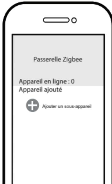
Cliquez sur "+" (ajouter un sous-appareil) pour sélectionner la passerelle de produit appropriée et suivez les instructions à l'écran pour l'appairage.
