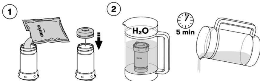
1. Fügen Sie das Filtergranulat in die Filterkartusche. Schließen Sie den Deckel der Filterkartusche.
