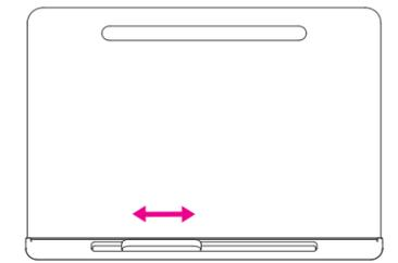
Le butoir pour ordinateur portable/livre peut être fixé dans n'importe quelle position de la rainure du repose-poignet selon les besoins.
