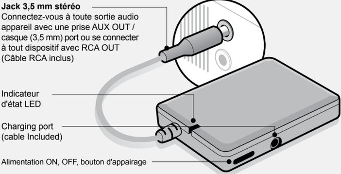
Remarque: Si vous souhaitez utiliser le ABT01F durant le chargement de la pile, branchez d'abord le câble de chargement avant de mettre l'appareil en marche.
