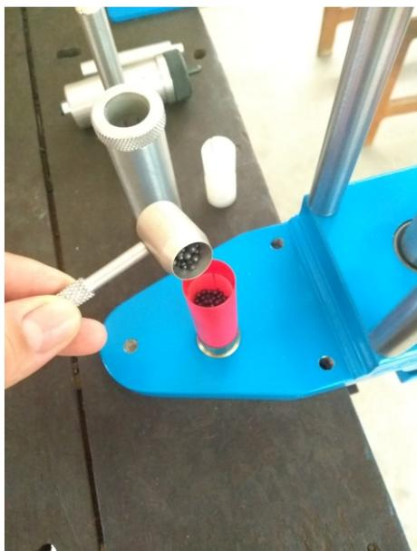
coloque manualmente uma medida de chumbo sobre a bucha de plástico dentro do cartucho
