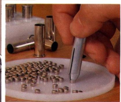
6. Rosqueie o reservatório na base ⑨, retire o grampo (E) do orifício e coloque-o na reentrância (F), localizada na extremidade superior da vareta (D). Coloque a vareta no reservatório, para que a mesma pressione as espoletas para baixo (foto ao lado).
