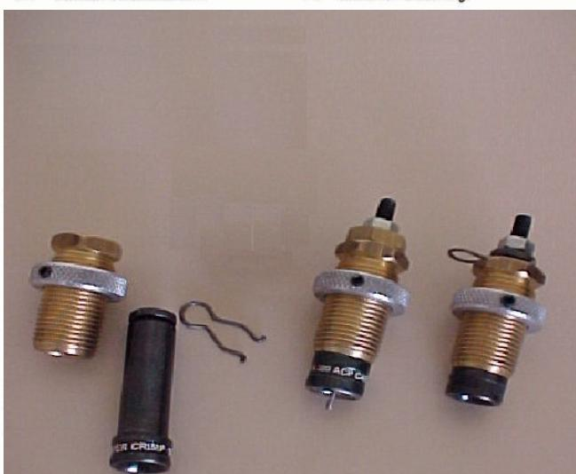
A foto acima mostra os três dies, todos em aço especial, utilizados na PAULA 2001. Cabe lembrar, que o primeiro die possui em sua extremidade um anel de carbide, material que garante grande precisão à calibragem da cápsula.
