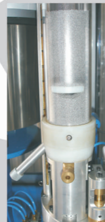
Alimentação automática de cápsulas, pólvora, projeteis e espoletas.
