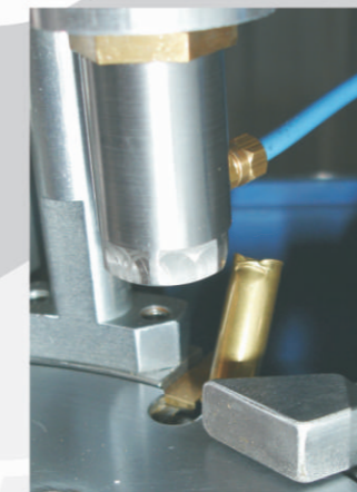
Rejeição automática de cápsulas defeituosas.
