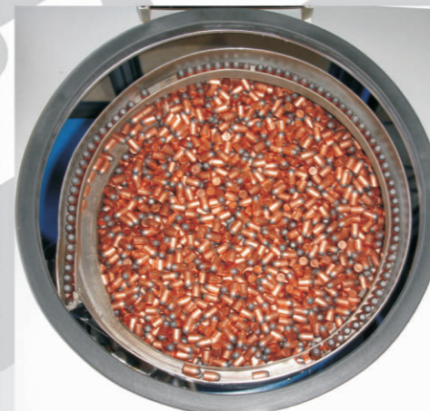
Alimentação automática de cápsulas, pólvora, projeteis e espoletas.
