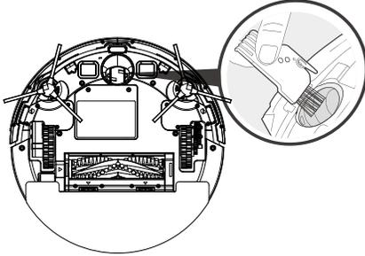
5. Optimum performansı sağlamak için sensör üzerindeki tozu temizlemek için temizleme fırçasını kullanın.
