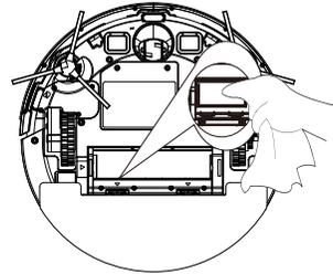
2. Rulo fırçayı temizleyin ve sağlanan temizleme aracını kullanarak rulo fırçanın üzerindeki tüyleri çıkarın.
