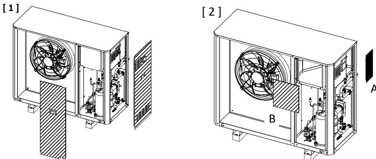
1. Rimuovere i due pannelli di accesso al vano componenti svitando le viti come riportato in figura 1
