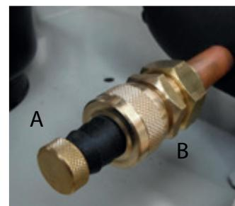
Nel caso si debba scaricare completamente l'unità, chiudere prima le saracinesche manuali di ingresso e uscita (non in dotazione) e quindi staccare i tubi predisposti esternamente su ingresso e uscita acqua in modo da far fuoriuscire il liquido contenuto nell'unità (per rendere agevole l'operazione, è consigliabile installare esternamente su ingresso e uscita acqua due rubinetti di scarico interposti tra l'unità e le saracinesche manuali).
