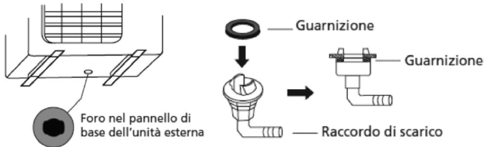
Ciascuna unità è quindi provvista, sulla base del kit idronico (in corrispondenza del lato della batteria), di un foro per lo scarico di questa eventuale condensa che possa percolare dai tubi dell'impianto idraulico. Essendo tali tubi ben coibentati, la produzione di condensa è comunque minima e pertanto non è obbligatorio collegare un tubo di drenaggio a tale raccordo.
