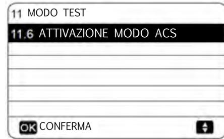
Durante la prova di funzionamento i tasti non sono operativi, ad eccezione di OK. Se si desidera interrompere la prova di funzionamento, premere OK. Ad esempio, quando l'unità è in modalità di spurgo aria, premendo OK la schermata seguente compare:
