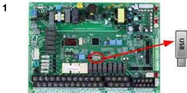
Con unità alimentata e in funzionamento **SPENTO** collegare la chiavetta alla porta USB della scheda unità interna.
