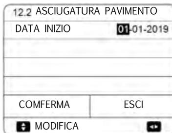
Per i sistemi di riscaldamento a pavimento di nuova installazione, la modalità di asciugatura a pavimento può essere utilizzata per rimuovere l'umidità dalla soletta e dal sottopavimento per evitare la deformazione o la rottura del pavimento durante il funzionamento del riscaldamento a pavimento.
