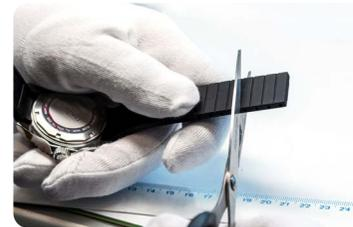
Vergleichen Sie den Umfang Ihres Handgelenks mit der gemessenen Gesamtlänge von Band, Uhr und SchlieÙe. Kürzen Sie beide Bandseiten gleichmäßig mit der Schere. Sind Sie unsicher, lassen Sie das Band zunächst länger.
