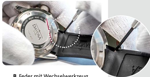
**B.** Feder mit Wechselwerkzeug herunter drücken, Federsteg in Position bringen und auf der anderen Seite einfädeln.
