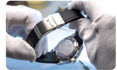
Achten Sie darauf, dass die Logos auf der SchlieÙe und der Uhr gleich ausgerichtet sind. So stellen Sie sicher, dass die SchlieÙe richtig herum montiert wird.
